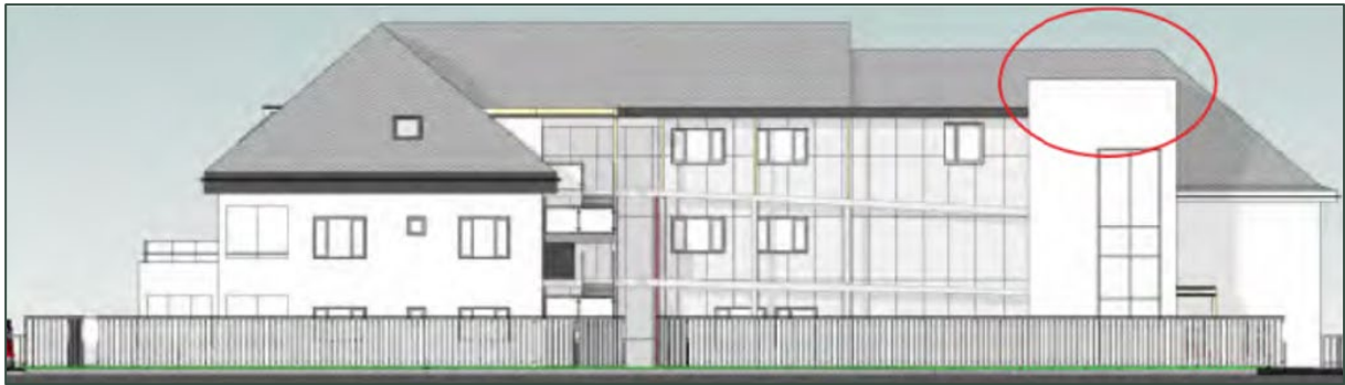
Figur 5 Trappe-/heistårn - som bygget.
