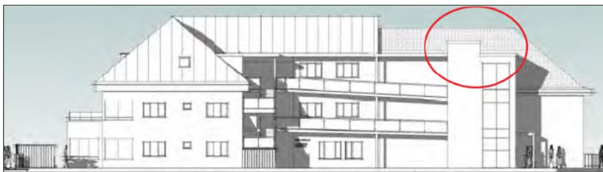
Figur 4 Trappe-/heistårn fra tidligere gitt tillatelse.
