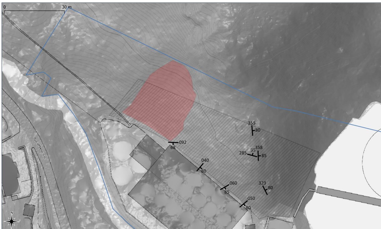
Figur 13 Kart med målinger av strøk og fall på lineamenter/sprekkeplan. Område med skredur er markert i transparent rødt.
