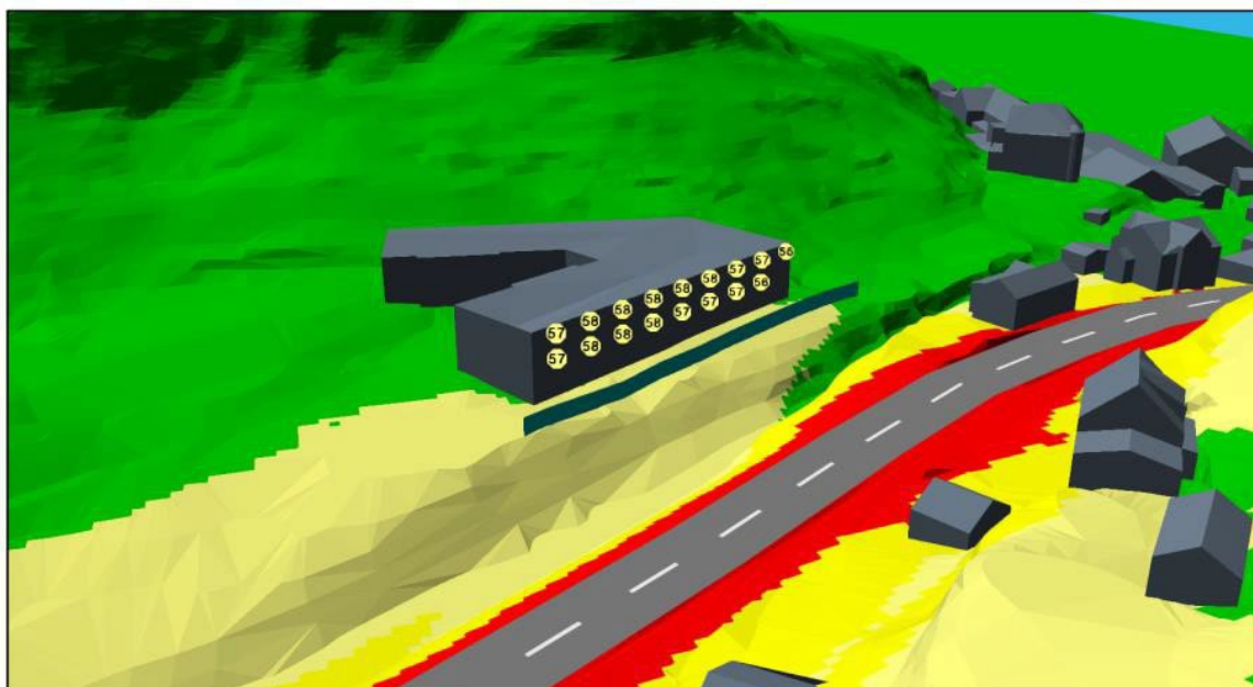
Figur 4-2: Fasadenivåer med støyskjerm på 2 meters høyde ved foreslått plassering av barnehagen. Fasadenivåer beregnet som L_{den} innfallende lydtrykk, støysone beregnet L_{den} 4 meter over terreng.
