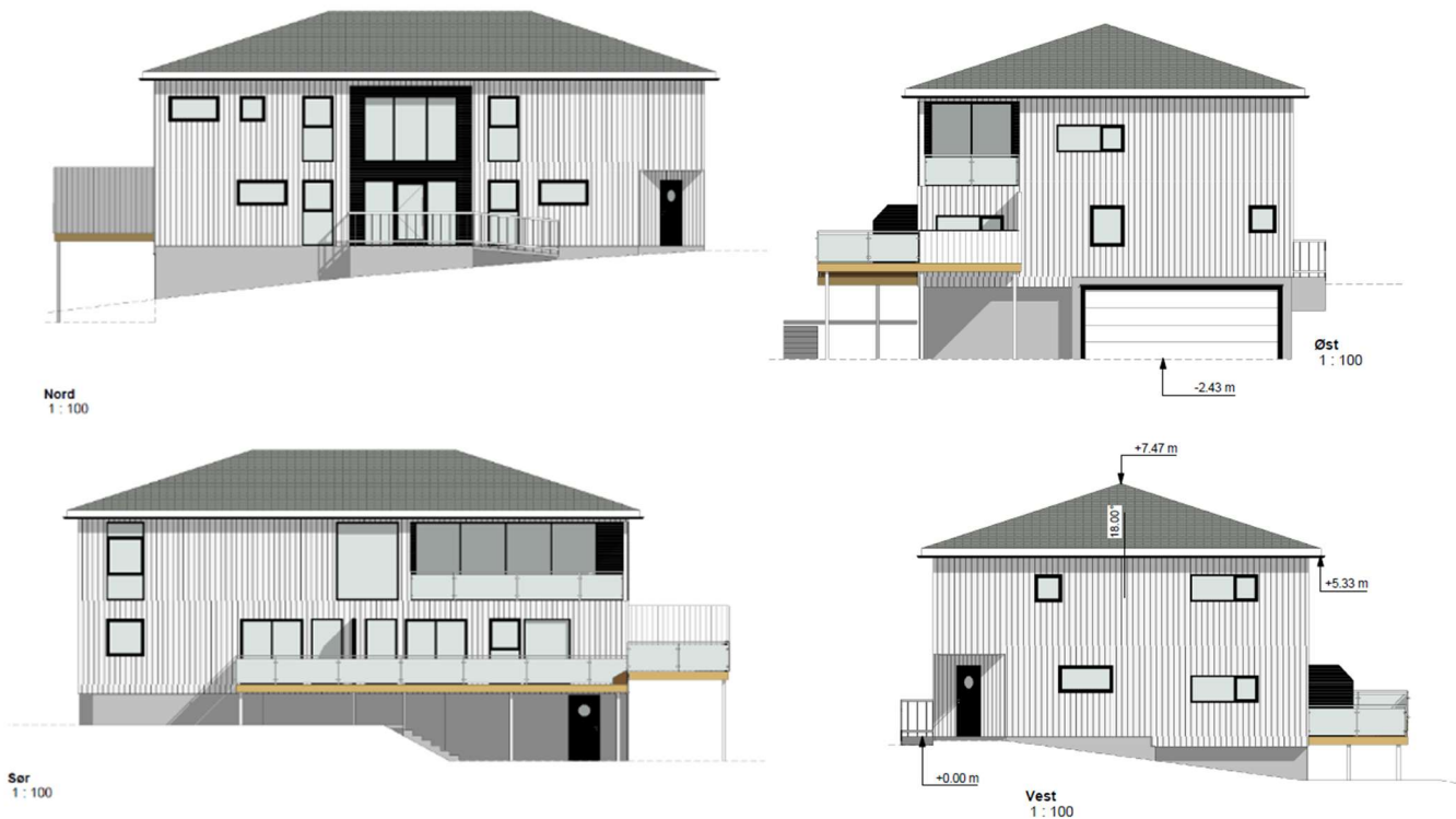
FIGUR 21: TEGNING VALMTAK - VIKESÅ BYGGPROSJEKTERING AS
