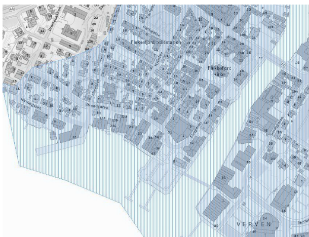
FIGUR 21: FILLMASSE - MULIGHET FOR MARINE AVSETNINGER - KILDE: NVE
